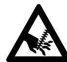
Rør ikke ved skærekivene, hvis motoren kører. Blokeres skærekivene af en genstand, skal motoren straks standses, låsegrebet stilles på og batteriet tages ud – først derefter må genstanden fjernes – **fare for kvæstelser!**
