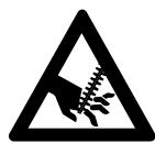
Vidrör inte knivarna när motorn går. Om knivarna blockeras av något ska motorn genast stängas av, spärrspaken ställas på
