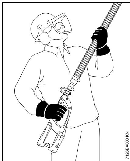
Asir firmemente las empuñaduras con los pulgares. La mano izquierda, en el tubo flexible de agarre; la derecha, en la empuñadura de mando.
