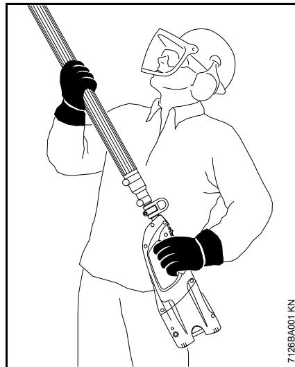
De handgrepen stevig met de duimen omvatten. De rechterhand op het handvatrubber op de steel, de linkerhand op de bedieningshandgreep.
