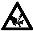
Non toccare le lame se il motore è in funzione. Se le lame vengono bloccate da un oggetto, spegnere subito il motore, spostare la leva di arresto su ⚡ ed estrarre la batteria – solo allora togliere l'oggetto – **pericolo di lesion!**
