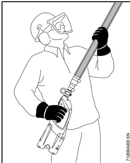
Entourer fermement les poignées avec les pouces. Tenir la gaine faisant office de poignée avec la main gauche et la poignée de commande avec la main droite.
