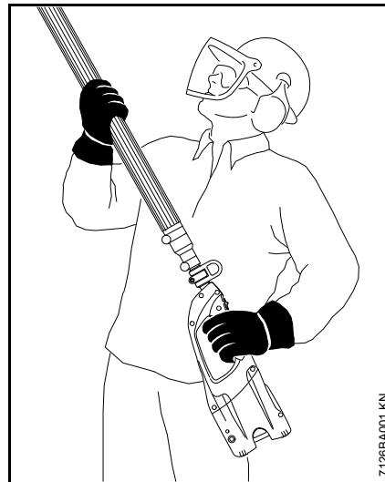
Entourer fermement les poignées avec les pouces. Tenir la gaine faisant office de poignée avec la main droite et la poignée de commande avec la main gauche.
