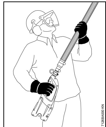
Abranger firmemente os cabos com os polegares. A mão esquerda na mangueira do cabo da haste, a mão direita no cabo de operação.
