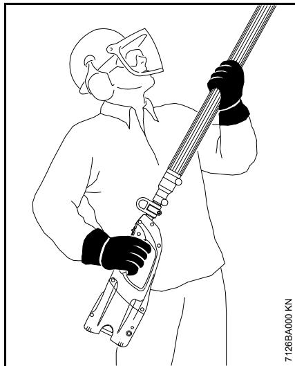
De handgrepen stevig met de duimen omvatten. De linkerhand op het handvatrubber op de steel, de rechterhand op de bedieningshandgreep.
