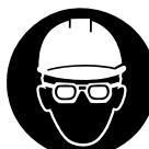
Para reduzir o perigo de ferimentos nos olhos, usar óculos de proteção justos conforme a norma EN 166. Certificar-se de que os óculos de proteção assentam corretamente.
